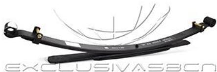
Lado de montaje: Eje trasero - Forma de resorte: Ballesta - número de ballestas: 2+2 - Ancho (mm): 60 - Longitud 1/Longitud 2 (mm): 565/635 mm - EAN: 8433573113372
